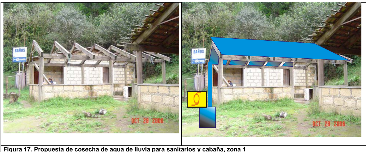
Figura 17. Propuesta de cosecha de agua de lluvia para sanitarios y cabaña, zona 1
