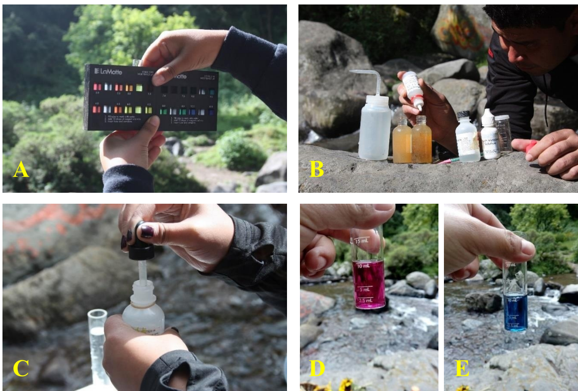
Figura 8. Análisis fisicoquímicos en el río Magdalena, CDMX. A) pH, B) Oxígeno disuelto, C) Turbidez, D) Alcalinidad y E) Dureza. Fuente: Trabajo en campo 2017.
