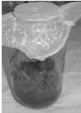
Figura 17.1. Frasco con tela para la prueba de toxicidad subcrónica con lombriz de tierra
