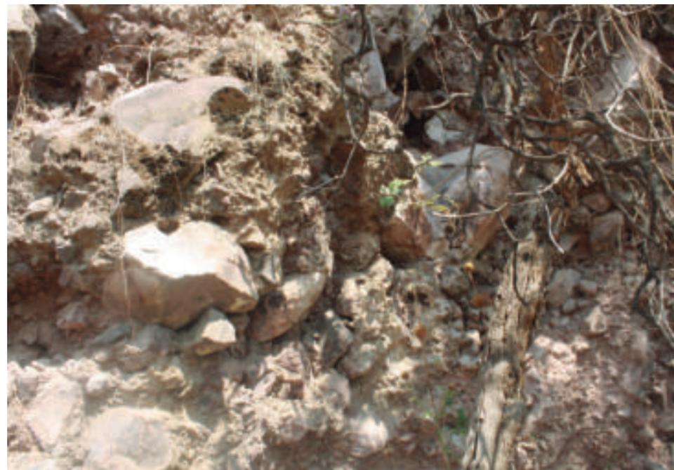
*Figura 5.69. Fotografía B del polígono de vulnerabilidad. Litología del terreno (fragmentos de basaltos contenidos en una matriz arcillosa) en la que se observa susceptible a sufrir deslizamientos. Este lugar es conocido como «Las Curvas» (19.2000° N, 99.0352° W. Avenida: Jalisco Oriente).*
