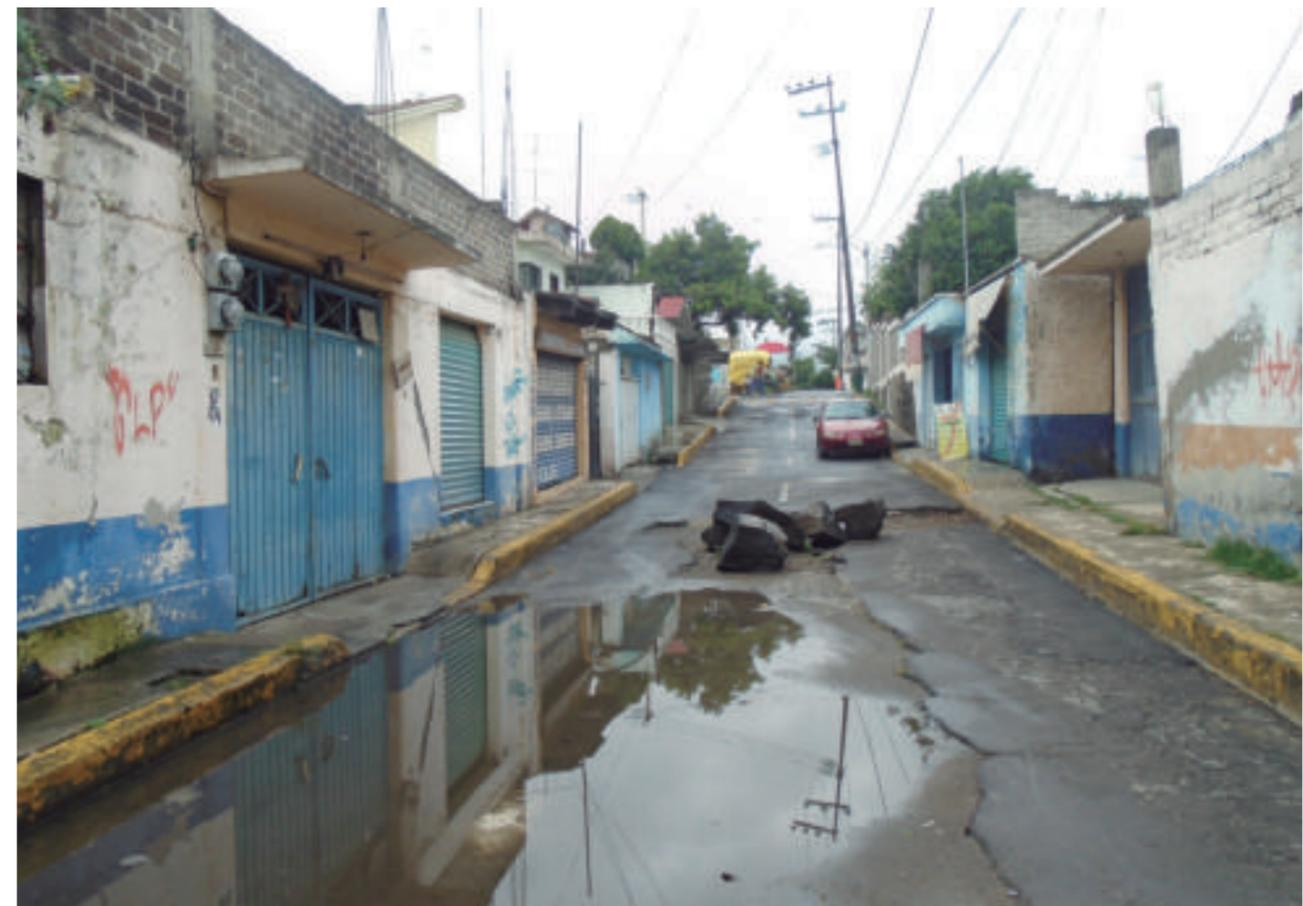
*Figura 5.122. Fotografía C de la zona de hundimiento y fracturamiento. Dos viviendas con daño severo (fracturamiento de sus muros) así como también agrietamiento en el asfalto. El hundimiento ha provocado que la calle se inunde en temporadas de lluvia (19.2154° N, 98.9913° W. Calle: Vicente Guerrero).*
