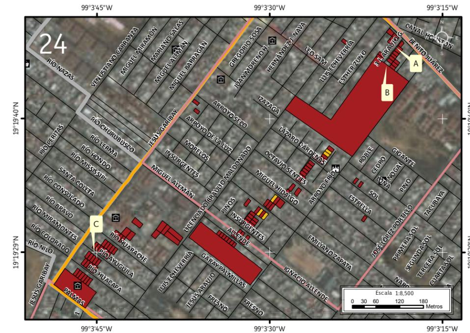
Figura 5.268. Imagen 24 de vulnerabilidad física expuesta a hundimiento local y fracturamiento en la colonia Consejo Agrarista Mexicano (Mapa XXIII).
