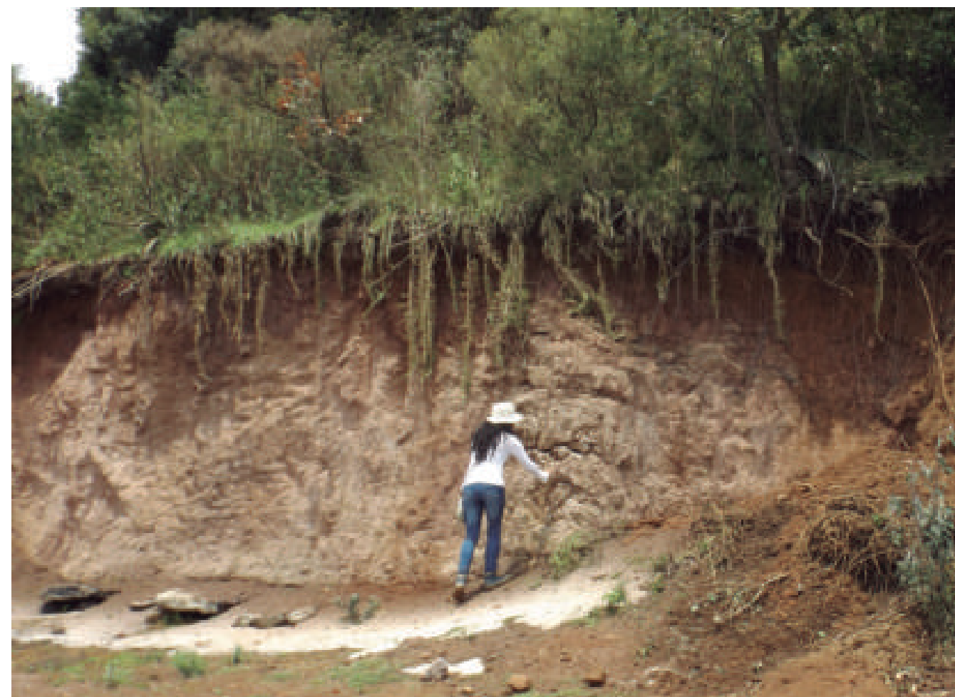
Figura 5.87. Fotografía D del polígono de peligro San Pablo Chimalpa. Talud vertical de 3 m de altura compuesto de depósitos volcánicos con un alto grado de intemperización. En la parte derecha de la fotografía se observan depósitos de derrumbe (19.3504° N, 99.3212° W. Calle: sin nombre oficial).
